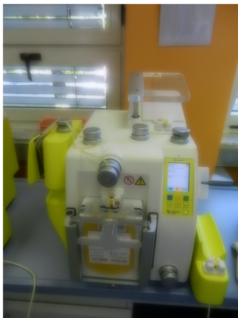
Slika 4: Aparat za avtomatsko ločevanje polne krvi (Compomat G5) in računalniški izpis
